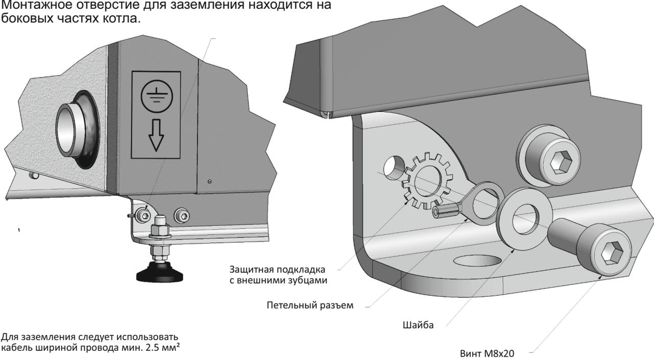
Для заземления следует использовать кабель шириной провода мин. 2.5 мм<sup>2</sup>
