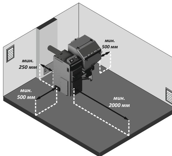
Рисунок 4. Установка котла в помещении котельной.
