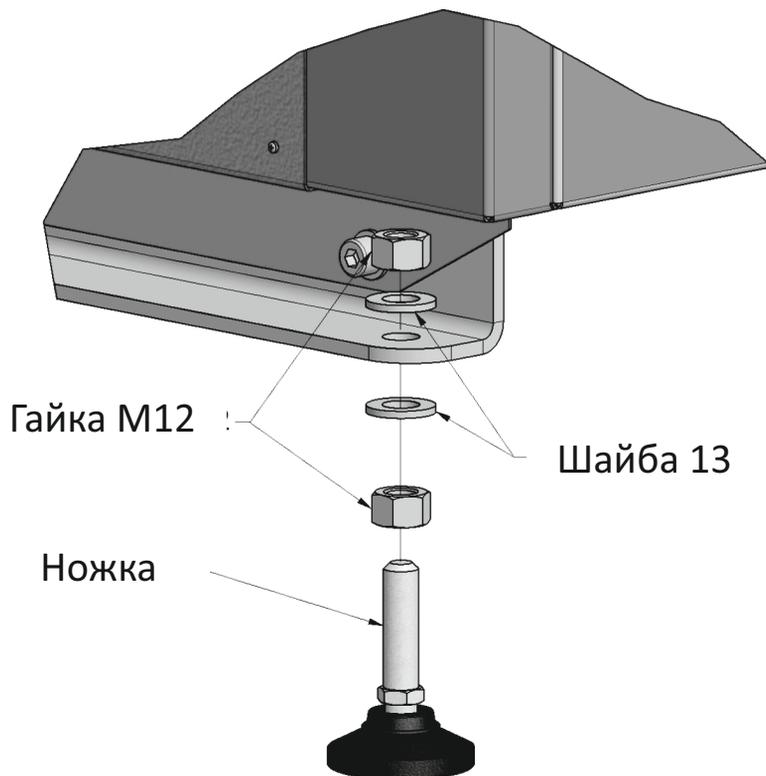
В комплектации котла находятся дополнительные регулирующие ножки, которые позволяют прочно установить котел на полу.
